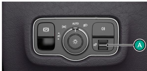
주간에는 계기판의 밝기 수준이 기본적으로 최대 밝기입니다. 해질녘과 야간에는 전면 유리 상단에 설치된 조명 감지 센서가 밝기 수준을 자동으로 미리 설정된 수준으로 낮춥니다.
