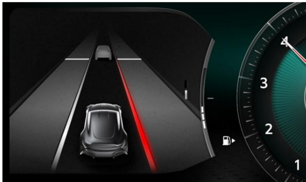
앞 바퀴 중 하나가 차선 표시를 넘어가면 차선 이탈 경고 기능이 먼저 핸들 진동과 계기판의 경고를 통해 차선을 벗어남을 경고합니다. 운전자가 경고에 반응하지 않으면, 차량의 차선 유지 보조장치가 가동되어 어느 한쪽을 짧게 제동함으로써 차량을 다시 정확한 차선으로 유도합니다.
