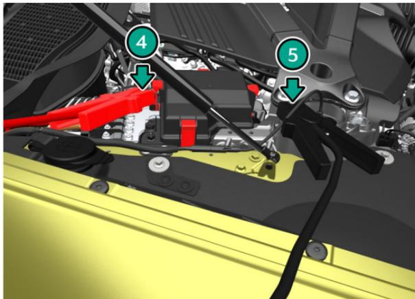
7. 도음을 줄 차량의 엔진을 시동하고 엔진 속도를 높여 약 1500~2000 rpm 으로 2 분 동안 가동합니다<sup>1</sup> .
