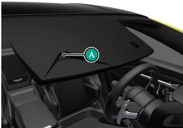
추가적인 주행 시스템이 올바르게 작동할 수 있도록, 카메라 앞부분 전면 유리를 항상 깨끗하게 유지해야 합니다. 카메라는 와이퍼 블레이드의 청소 영역 아래에 있으므로, 날씨가 나쁠 때 와이퍼를 사용하면 해당 부분 유리가 청소됩니다. 여름 등과 같이 장기간 비가 오지 않을 때는 먼지와 오물이 쌓이지 않도록 정기적으로 전면 유리 와이퍼를 작동해야 합니다.
