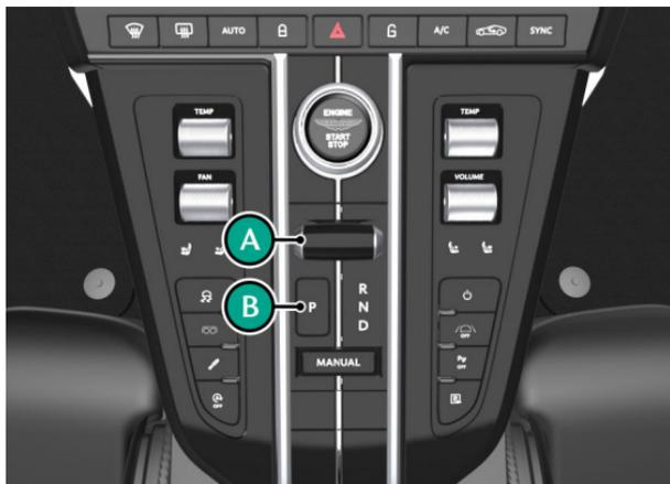
자동 모드에서는 하단 콘솔에 있는 변속기 선택기 레버(A)로 주행 모드가 선택됩니다. 전진 주행 중에는 도로 속도, 현재 선택한 기어, 가속 페달을 누르는 힘 등 다양한 주행 매개변수에 따라 자동으로 기어 변속이 이루어집니다. 차량이 정지 중일 때는 변속기가 1 단으로 유지되며 가속 페달을 누르는 즉시 출발할 수 있도록 준비합니다.
